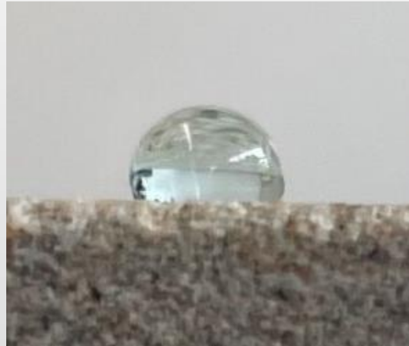
Hydrophobie + raue Oberflächenstruktur => „Lotus-Effekt“
