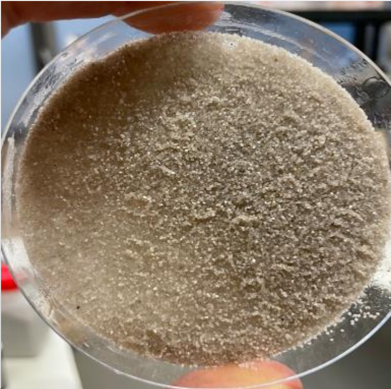
loser Sand verfestigt sich in 6 - 12 h
