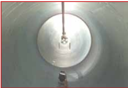
Milchtanker innen mit SiO 2 beschichtet.
