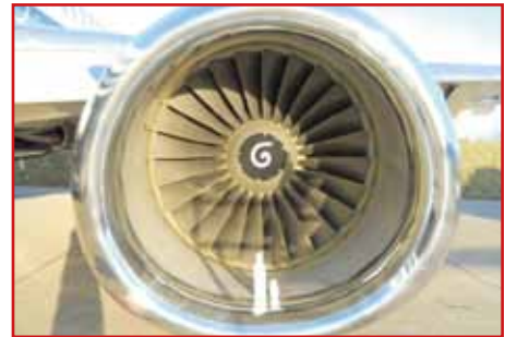
SiO 2 Beschichtung auf einer Boeing 737
